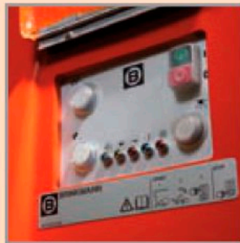
Über die Bedientafel wird der Estrichboy gesteuert. Sie ist durch eine stabile Klappe vor Beschädigung und Schmutz geschützt.
