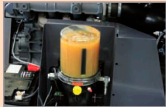
Der DC 450 ist serienmäßig mit einer leistungsfähigen Fettzentralschmierung ausgestattet.
