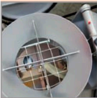
Blick in den Druckkessel mit seinen verschleißfesten Mischflügeln und Verschleißblechen.
